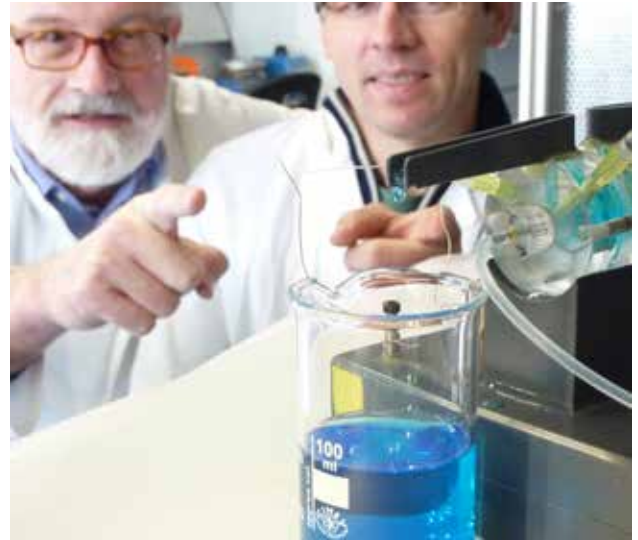
In der sogenannten Ussing-Kammer werden Transportvorgänge an der Atemwegsschleimhaut untersucht.
